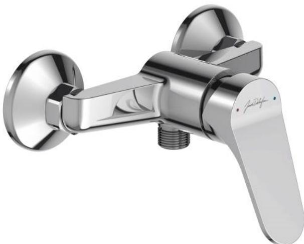
Mitigeur douche mural. Bague-limiteur de température. Raccords et rosaces murales. Economie d'eau : limiteur de débit sensitif. Débit : 12 l/mn sous 3 bars. Avec raccords et rosaces murales. Cartouche à disques céramique. Entraxe : 150 +/- 15mm. Clapet anti-retour sur la sortie douche.
