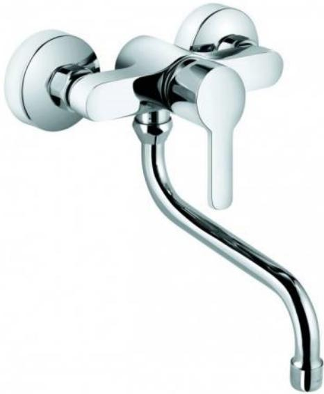
Mitigeur d'évier pour montage mural. Levier plein. Débit classe A. Mousseur. Cartouche céramique avec limiteur eau chaude. Bec d'écoulement orientable (360°) G 3/4 x 200mm. Raccordements S.
