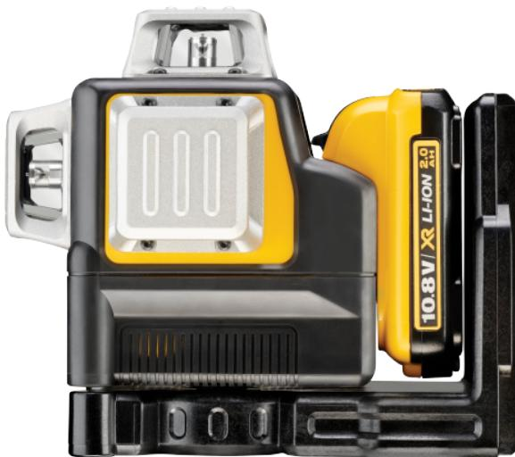
3 faisceaux 360°. Diode pulsée compatible avec le récepteur. Faisceau vert 3 fois plus visible à l'oeil nu. Projette des lignes horizontables et verticales. Portée 30m (60m avec le récepteur). Précision: +/-3mm@10m. Raccordement à un trépied.
