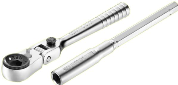
La compacité de la tête procure un accès exceptionnel lors de l'utilisation d'embouts 6 pans 1/4". Tête flexible à 180°. Le bouton permet de verrouiller la tête en position. 13 positions de verrouillage. Mécanisme 60 dents pour une reprise à 6°. Inversion par levier : facile même main gantée. Permet la visualisation du sens de rotation. Utilisation avec douilles carré 1/4" grâce à l'adaptateur ECR.1. Livré avec une rallonge magnétique traversante 100mm permettant l'utilisation "poignée en T".
