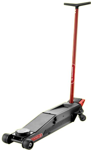
Hauteur de levée maximum : 470mm. Hauteur minimum de prise sous caisse : 95mm. Hauteur maximum du châssis : 135mm. Pédale d'approche rapide. Dispositif "homme mort". Régulation de la vitesse de descente. Dispositif de sécurité supplémentaire: blocage mécanique à 320mm (avec une 2ème pédale de déblocage), le cric ne peut pas descendre accidentellement. Conforme à la directive machine 2006/42/CE - Norme EN1494+A1. -Protection caoutchouc de la platine.
