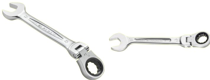
Clés mixtes à cliquet à tête articulées : permettent d'atteindre les écrous difficiles d'accès. Mécanisme à cliquet compact et réversible par retournement de la clé. Angle de reprise à 5°. Tête oeil articulée à 180°. Tête fourche inclinée à 15°. Finition chromée satinée.
