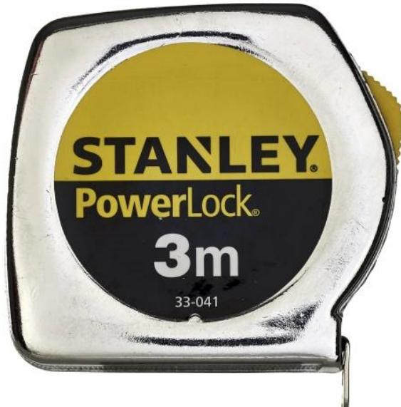
Revêtement Mylar haute protection et anti-abrasion sur la totalité du ruban: durée de vie multipliée par 10 par rapport à un ruban traditionnel. Boîtier métal chromé très résistant aux chocs. Blocage du ruban et retour automatique. Mesure intérieure par addition de 5 cm. Crochet 3 rivets offrant une bonne résistance à l'arrachement. Crochet avec position du zéro réel : pour mesures intérieures et extérieures. Agrafe pour port à la ceinture.
