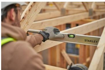
Corps tubulaire en aluminium léger avec zones de renforcement et avec peu d'aspérités. 3 fioles réversibles haute visibilité : 1 horizontale et 2 verticales. Fioles acryliques monoblocs scellées dans le niveau : indéréglables. Semelles usinées des 2 côtés dont 1 aimantée. Revêtement protecteur anti-abrasion. Embouts de protection renforcés haute résistance aux chocs. Poignée bimatière vissée : contrôle et prise en main améliorée. Précision : +/- 0,5mm/m.
