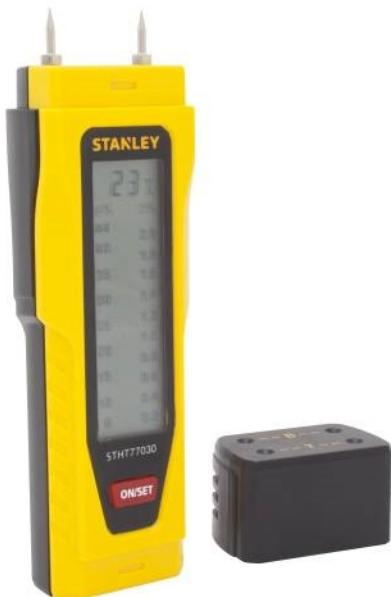
Double unité de mesure. Ecran LCD avec graphique. Mesure humidité de bois de 6% à 44% (précision +/- 2%). Mesure humidité de bâtiments de 0,2% à 2% (précision +/- 1%).
