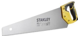
Scie égoïne jet cut hp 7 dents/pouce. Épaisseur de lame de 0.85 mm pour éviter le flambage de la lame. Traitement de denture HARDPOINT avec avoyage alterné :
