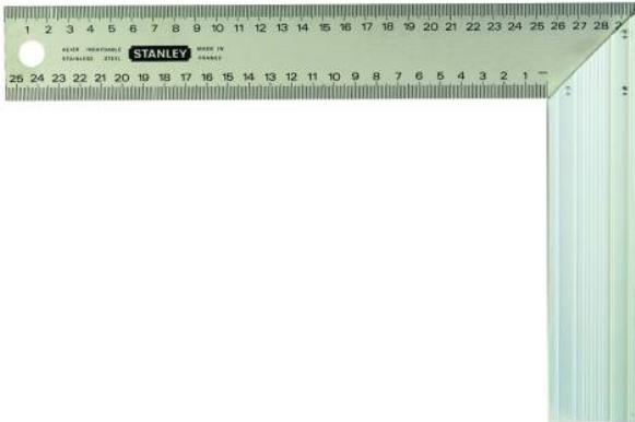
Lame en acier inoxydable - graduation millimétrique par photogravure pour une excellente visibilité (Procédé Gravemat). Talon profilé en aluminium extrudé pour une meilleure durabilité et une grande précision. Graduation millimétrique recto verso - Classe 2. Talon pour le traçage d'angles à 90° et 45°.
