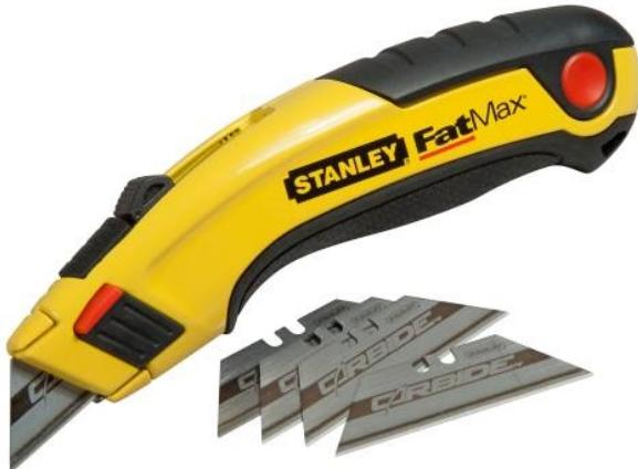
Système "Instant Change" : remplacement frontal de la lame sans outils par simple pression sur le bouton. Réglage de sortie de la lame sur 4 positions différentes selon la profondeur de coupe. Plus de robustesse avec un corps en acier et un revêtement bi matière. Accès immédiat au réservoir de 5 lames. Livré avec 5 lames trapèze longue durée au carbure de tungstène.
