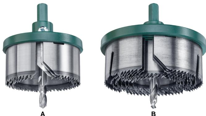
Scie trépan, plateau support lourd en zinc coulé sous pression, couronnes de sciage en acier ressort trempé, pointes des dents traitées par induction, pour bois, bois revêtus de matière plastique, bois dur, panneaux agglomérés, plaques de plâtre, panneaux de construction légère et matière plastique. Profondeur de coupe 30mm.
