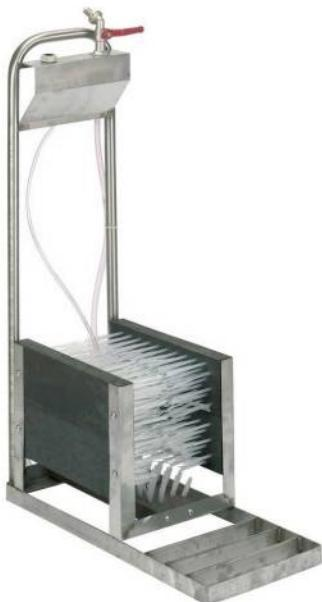
Lave botte à structure en acier inoxydable équipé de 5 brosses. Grattoir sur le devant du lave botte. Alimentation par secteur d'eau. Irrigation sur les 2 côtés et le dessous. Dispositif pour mélange désinfectant / nettoyant. Vanne d'arrêt d'eau intégrée. Raccord eau sur embout fileté mâle 20/27. Raccord de durite 1/2" également fourni. Epaisseur de tôle : 3 et 1mm.
