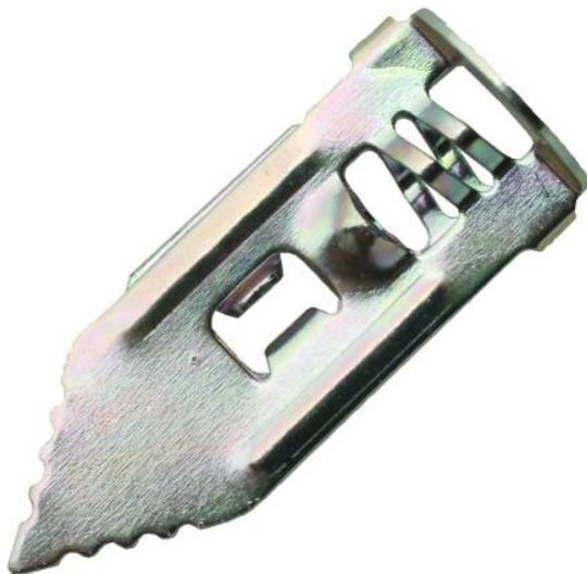
Cheville métallique à frapper RAYFIX. Pointe dentelée pour une insertion facile sans perçage et filet de guidage pour centrer la vis. Spéciale plaque de plâtre et fonctionne également dans les portes auréolées. Pour cloisons de 9 à 13mm d'épaisseur.
