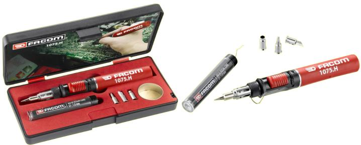
Température de la panne : 250°C ~ 550°. Chalumeau : 1100°C. Température maxi : 1300°C. Allumage par piezo. Contenance en combustible 10 ml. Durée d'utilisation (pour une recharge) 55 min. Temps de chauffe : 40 sec. Puissance : 24 Watts. Rechargeable au gaz butane (fer livré vide). 4 pannes à souder, 1 distributeur de soudure.
