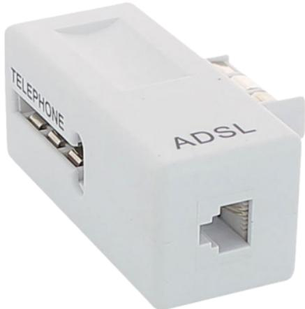
La pose de filtre ADSL est une composante indispensable d'une connexion ADSL fiable. Le rôle de ce filtre est de séparer les signaux ADSL (Internet), des signaux du téléphone "classique". Il est nécessaire de placer un filtre sur chaque prise téléphonique utilisée par un appareil sans quoi vous pourrez constater des dysfonctionnements de la connexion Internet ou encore des parasites sur votre ligne téléphonique.
