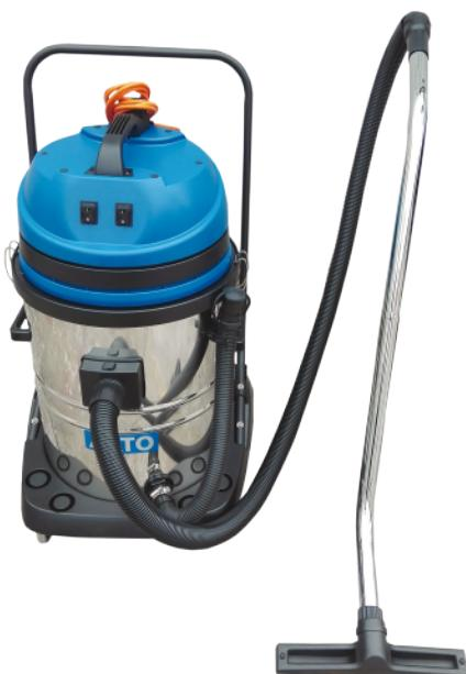
Aspirateur MAXXI avec 2 moteurs conçus pour l'aspiration des poussières ainsi que les liquides. Idéal pour l'aspiration des véhicules grâce aux buses qui se montent directement sur le flexible. Le filtre synthétique lavable permet une utilisation sans sac pour les poussières grossières. Cuve Inox AISI 201 de grande capacité. Moteurs By-Pass à refroidissement indépendant. Filtre permanent lavable. Filtre à eau anti mousse disponible en accessoire. Rangement facilité des accessoires.
