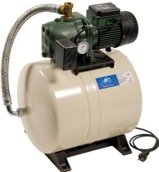
Groupe surpresseur automatique AQUAJET 102-60 M équipé d'une pompe DAB Jet 102 et d'un réservoir à diaphragme de capacité 60L, particulièrement adaptés pour la surpression domestique (appartements, villas, chalets, fermes, etc.) à partir d'un puits ou d'un réservoir. Fonctionnement entièrement automatique grâce au contacteur manométrique qui démarre et arrête la pompe, en fonction de la demande en eau.
