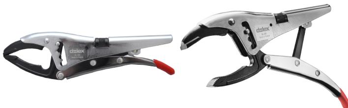
Protection des mors par cataphorèse, résistance au brouillard salin. Une denture des mors étudiée pour un serrage renforcé. Serrage et déverrouillage d'une seule main. Prise en main ergonomique. Grande qualité des composants : carter et poignée plus épais. Des encoches plus nettes pour une meilleure tenue de la goupille. Des rivets plus résistants pour une manipulation à l'infini. 6 positions.
