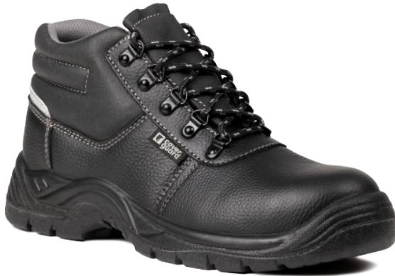
Chaussure de sécurité haute. Dessus en cuir enduit PU embossé 1,6/1,8mm. Doublure Mesh. Semelle Polyuréthane. Protection par embout acier 200J et semelle anti-perforation acier. Absorption d'énergie par le talon. Chaussure imperméable, semelle antistatique, anti-dérapante et résistante aux huiles et hydrocarbures.
