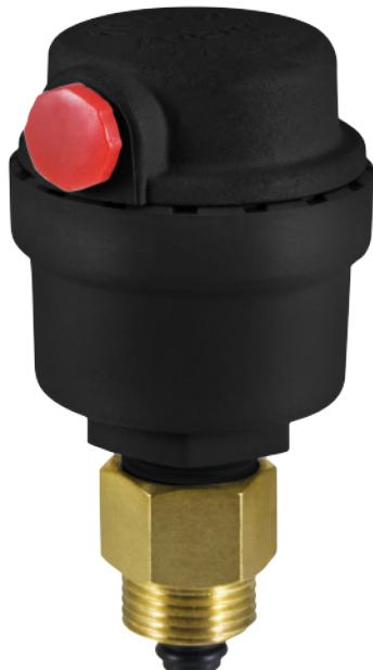
Corps polymère avec clapet anti retour. Température max 100°. Pression 6 bar. Pression decharge 4 bars. Fluides : eau et eau glycolée.
