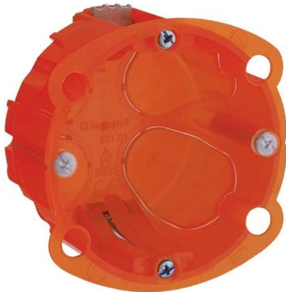
Mise en place par injection de colle pour scellement rapide, par scellement sur murs maçonnes (parpaing, briques...), par serrage d'étrier métalliques en cloison creuses (plaques de plâtre, briques) ou sur carreaux de plâtre. Boîte à rigidité renforcée. Profondeur 40mm. Livrées avec vis équipées de cache de protection.
