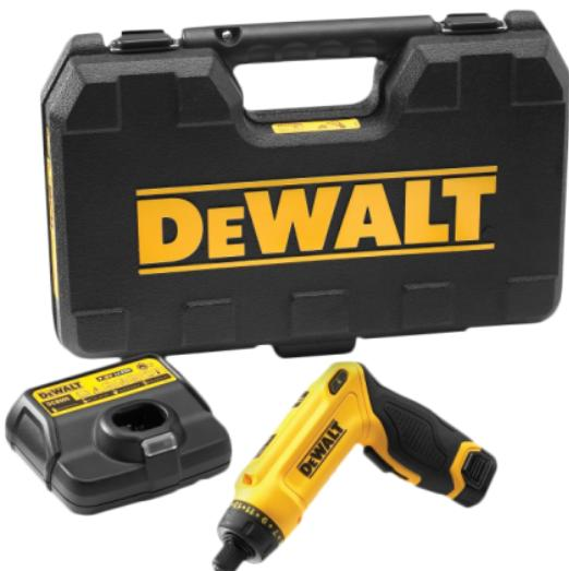
Système gyroscopique à vitesse variable (jusqu'à 430T/min) pour un contrôle parfait. Tournevis 7,2V idéal pour les vissages légers. Poignée ergonomique mobile pour toutes les applications. Réglage de couple à 16 positions permet un contrôle parfait de la profondeur lors de travaux répétitifs. L'indicateur de charge évite le changement intempestif de batterie en pleine action. Les double LED assurent une visibilité parfaite.
