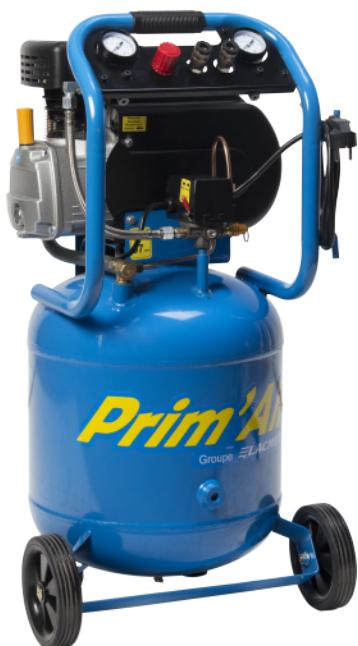
Tableau de bord avec régulateur, manomètre de pression de cuve, manomètre de pression réglée, soupape de démarrage, 2 sorties raccords rapides, clapet anti-retour, soupape de sécurité, robinet de purge, roues pleines 170mm, tuyauterie en aluminium 8x10mm avec protection, cordon d'alimentation 1,6m (3x1,5mm<sup>2</sup>).
