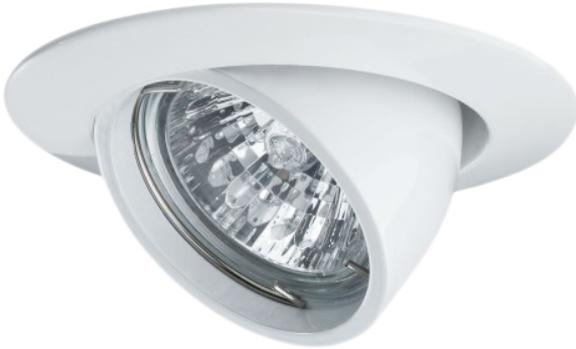
Spot encastré Premium Line blanc de diamètre 51mm , orientable. Ce type d'encastré peut utiliser des ampoules 12V GU5,3 LED ou halogène (voir ampoule adaptée). Matériel de construction en Alu zinc. Orientable jusqu'à 45°. Type de protection : IP23 (pour montage au plafond). La profondeur d'encastrement est de 58mm. Classe de protection III. Fourni avec connecteur. Changement d'ampoule particulièrement rapide et simple grâce à l'ingénieux système Easy-Click. Livrés sans ampoule.
