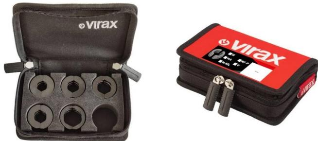
Cette mallette Virax comporte cinq inserts de type V, spécialement conçus pour les tubes et raccords cuivre. Elle inclut des inserts de 12, 14, 16, 18 et 22mm. Le sixième emplacement prévu convient pour le rangement d'un insert supplémentaire, d'une empreinte différente ou d'un gabarit qui n'est pas proposé dans cet ensemble.
