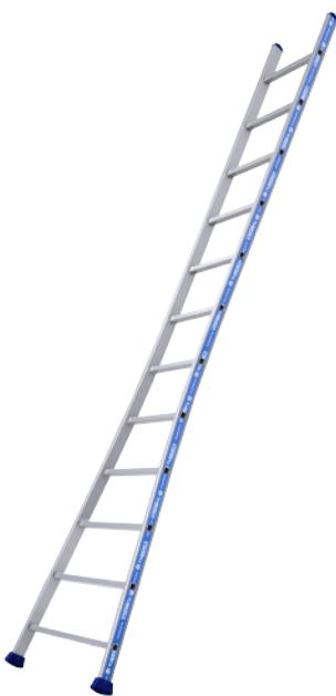
Echelle Platinium simple évasée tout en aluminium, sa base évasée et ses sabots enveloppants haute sécurité garantissent une parfaite stabilité. Pour un usage ultra intensif. Très simple à manipuler, grande stabilité. Échelons 30x30mm striés. Sabot enveloppanthaute sécurité. Profils renforcés. Répond aux normes EN 131 et au décret 96333, label NF, GS et VGS.
