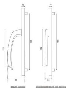
Carré à montage rapide. Plaque étroite 24mm. Saillie réduite pour passage de volet roulant (code 555553).
