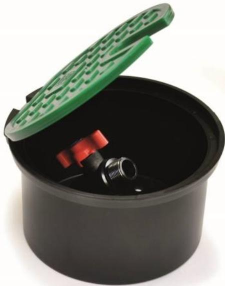
Regard en polypropylène, trappe avec ouverture pour tuyau. Vanne à sphère en polypropylène MF 3/4". Résistance température -30°C/+60°C. Pression nominale 16 bars.
