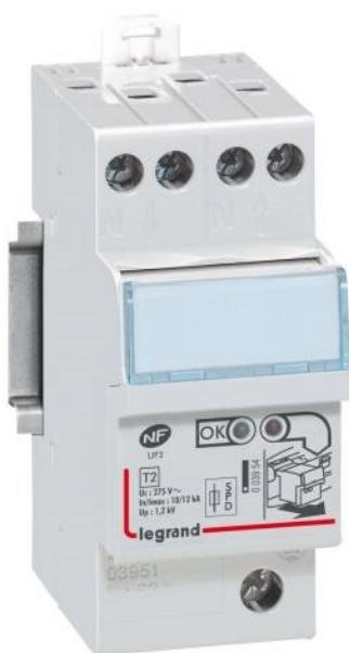
Parafoudre monophasé monobloc autoprotégé pour tableau d'abonné. Pour installations domestiques et petit tertiaire. Courant de court-circuit inférieur ou égal à 4,5 ka. Cassettes débrochables avec voyants de signalisation, vert parafoudre en état de fonctionnement, rouge cassette à remplacer. Parafoudre basse tension type 2 avec protection intégrée contre les courants de surcharge et les courants de court-circuit. Conforme aux normes NF en 61643-11 et iec 61643-1.
