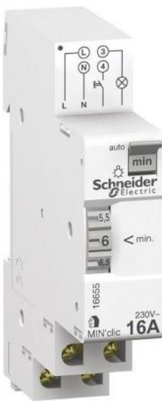
La minuterie permet la commande d'un circuit d'éclairage pour une durée réglable comprise entre 1 et 7 minutes. Situé en face avant, le commutateur de cette minuterie possède 2 positions : marche automatique (temporisation relancée automatiquement suite à une action sur un bouton poussoir) et marche forcée (éclairage permanent) ce type de minuterie dispose d'une autoprotection contre un courant de fuite trop élevé sur sa ligne de commande.
