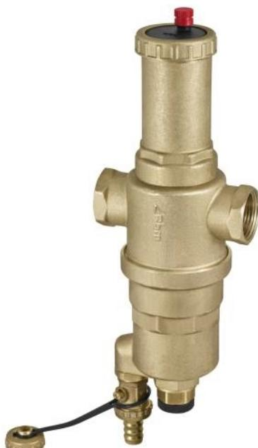
Le désemboueur magnétique permet l'élimination des particules (sable, rouille...) et de l'air dans le circuit de chauffage. Le purgeur d'air automatique est équipé d'un flotteur. Le système de filtration est magnétique auto nettoyant avec aimant de 11 000 Gauss. Corps en laiton équipé de vannes de vidange. Cartouche de filtration en Inox 304 avec aimant en néodyme.
