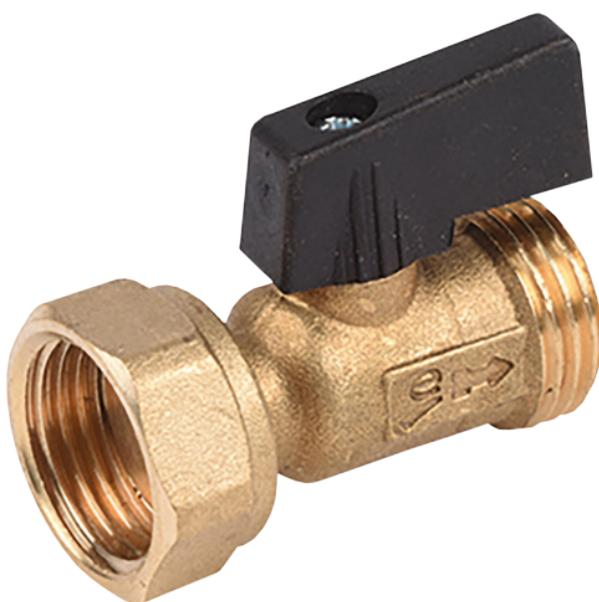
Vanne de dérivation. Vanne monobloc à sphère FM1/2" avec écrou tournant. Poignée papillon en plastique noir, corps en laiton CW617N, sablé. Résiste à une température maximum de 80°C et une pression maximum de 10 bars.
