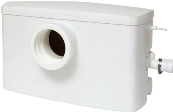
Le poste de relevage est prévu pour relever les eaux usées (avec des matières fécales) dont la collecte est en dessous du niveau du collecteur de rejet. Il est prévu pour une installation hors sol. L'arrivée des effluents est prévue pour un WC ainsi que 2 entrées supplémentaires et le refoulement est en diamètre intérieur 28mm avec le clapet anti-retour.
