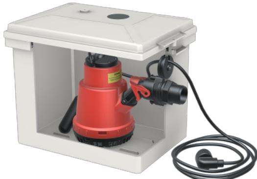
Le poste de relevage est prévu pour relever les eaux usées (sans matières fécales) dont la collecte est en dessous du niveau du collecteur de rejet. Il est prévu pour une installation hors sol. L'arrivée des effluents est à percer selon les besoins clients et le refoulement est en diamètre 40 (DN32) ou R1'1/2 avec le clapet anti-retour.
