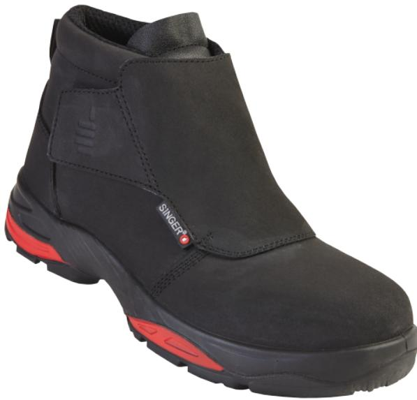
Tige haute en croûte Nubuck enduite, hydrofuge. Doublure textile haut de quartier. Semelle intérieure complète et amovible, textile antiperforation et embout anti-choc en composite 200J. Absorption d'énergie du talon. Semelle H.R.O caoutchouc nitrile. Languette soufflet. Surpiqûre noires traitées retardateur de flamme. Fermeture par rabat cuir et bande auto-agrippante. Fermeture et ouverture rapide.
