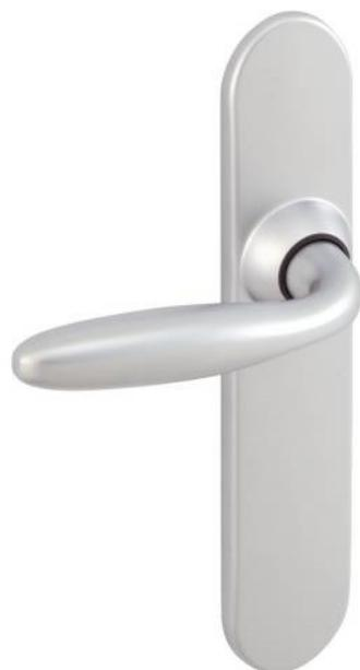
Ensemble monobloc : bâquille et plaque solidarisées. Plaque fondue avec piliers taraudés intégrés et vis invisibles côté extérieur. Entraxe 195mm.
