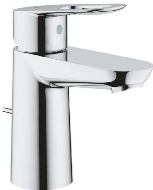
Mitigeur monocommande lavabo (taille S). Monotrou sur plage. Levier de commande métallique. Cartouche en céramique 28mm Grohe Longlife. Chrome éclatant et durable Grohe StarLight. Mousseur 5L/min GROHE EcoJoy économie d'eau. Système de montage rapide. Garniture de vidage plastique 1"1/4. Flexibles de raccordements souples, sertis d'usine.
