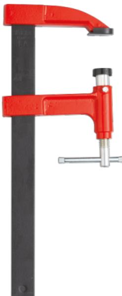
Serre-joints à pompe, rail en acier laminé protégé par cataphorèse. Puissance de serrage jusqu'à 10000N. Frein de blocage. Protections plastiques aux mors. Valet et coulisseau en fonte GS, protégés époxy.
