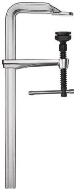
Puissance de serrage jusqu'à 12 000N pour un couple de 40Nm. Avec son nouveau profil en U, le rail permet une meilleure absorption et répartition des puissances de serrage. La rotule haute performance offre une longévité exceptionnelle grâce à son insert en acier hautement lubrifié, inclinable jusqu'à 35°.
