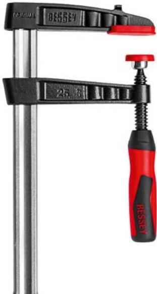
Puissance de serrage jusqu'à 6 000N. Poignée bi-matière de forme ergonomique. Rotule amovible et interchangeable sans outil et sans effort. Protections plastiques à la rotule et au valet. Rail profilé, étiré à froid, cranté, zingué avec grande résistance à la flexion. Frein de blocage du coulisseau sur le rail.
