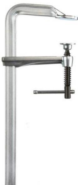
Avec son nouveauprofil en U, le rail permet une meilleure absorption et répartition des puissances de serrage. Puissance de serrage jusqu'à 6 000N. Rail et valet monobloc et coulisseau forgé, traités. Poignée à garrot à bouts ronds pour un bon confort au serrage. Rotule amovible et interchangeable sans outil et sans effort.
