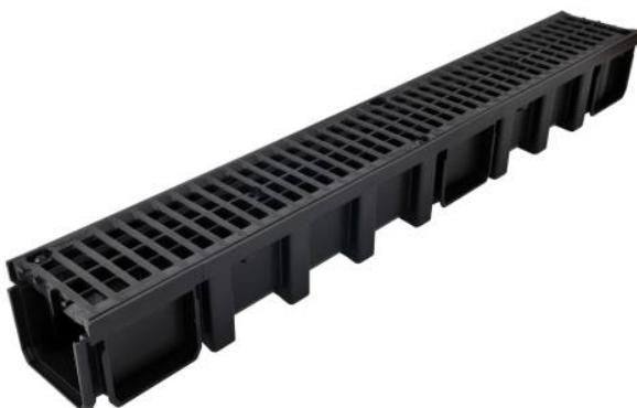
Caniveau en polypropylène avec grilles en fonte à recouvrement (sans feuillure). Caniveau livré avec deux grilles de 1m de longueur. Permet l'évacuation des eaux de ruissellement. Il peut être utilisé en domaine privatif pour toutes les applications du bâtiment, de l'environnement de la maison, des parcs et jardins en classe B125.
