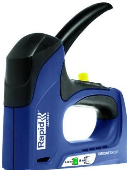
Réglage de force 3 niveaux breveté. Design ergonomique avec des surfaces souples et confortables. Corps en aluminium à la fois résistant et léger. Chargeur pleine bande tout acier pour agrafes et pointes et de fabrication suédoise pour une meilleure robustesse. Chargeur Dual pour agrafes et pointes : No140 6-14 mm & No8 pointes 15mm. Chargement par le dessous, chargeur pleine bande: 84 agrafes / 90 pointes.
