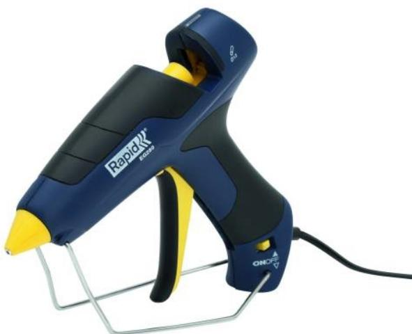
Débit de colle jusqu'à 600 g/h avec un mécanisme d'alimentation optimisé. Poignée avec revêtement souple antidérapant et gâchette 4 doigts pour plus de confort. Buse interchangeable. Support large et démontable pour une meilleure stabilité. Interrupteur ON/OFF. Bâtons de colle 12mm. Temps de chauffe moins de 3 min.
