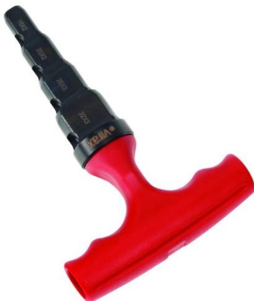
Double fonction : calibrage et ébavurage intérieur. 4 diamètres pour calibrer les dimensions les plus utilisées. Deux fonctions incontournables pour sertir le tube multicouche : recalibrer le tube après l'opération de coupe, ébavurer l'intérieur du tube pour éviter de blesser le joint torique du raccord. Produit résistant, corps en acier bruni, dureté 95 HrB. Poignée plastique pratique.
