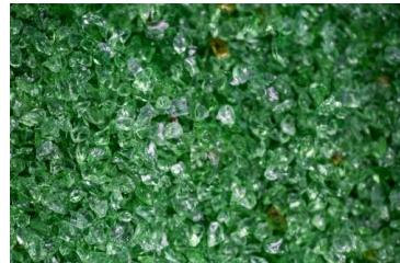
Média filtrant à base de verre recyclé activé. Il remplace intégralement le sable et permet d'optimiser la qualité de filtration et de réduire la consommation des produits de désinfection. La granulométrie de cette référence est Grade 2 (1-2mm).
