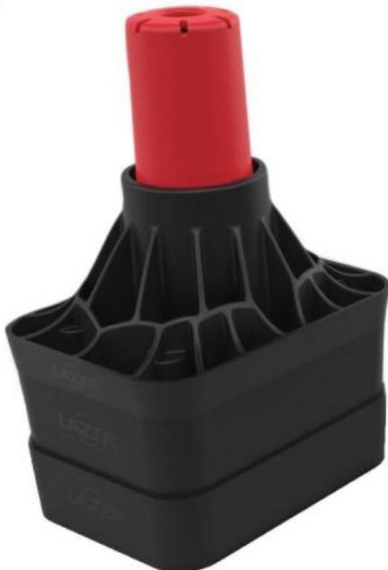
Système breveté de réglage automatique et autonivelant par l'intermédiaire de vérins. Pour tous types de receveurs(extraplats, à poser, à encastrer). Pose rapide : 30 min (temps de prise compris). Tenue sous charge de 1 tonne par pied. Réglage au départ par 4 cales périphériques. Collage des pieds par résine de scellement fournie. Ajout possible de rehausse sur les pieds.
