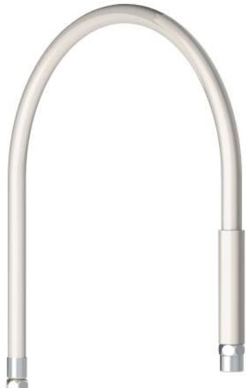
Flexible blanc armé qualité alimentaire. Blindage PVC sur la zone d'effort. Écrou tournant antitorsion. Flexible résistant à une température allant jusqu'à 70°C et une pression de 5 bar maximum.
